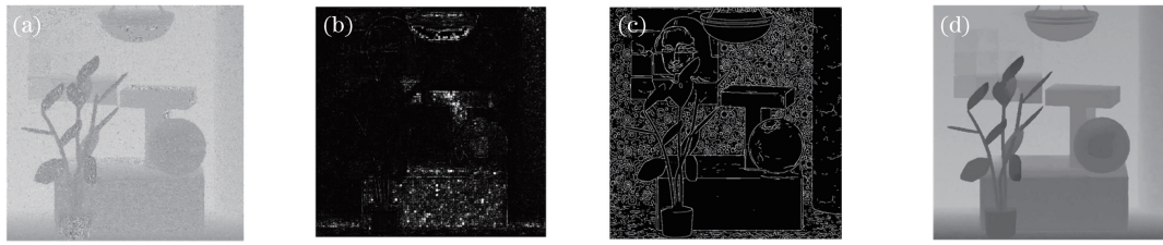
图 7 图像结果。(a)初始深度图;(b)置信度图;(c)边缘检测结果;(d)最终深度估计结果
