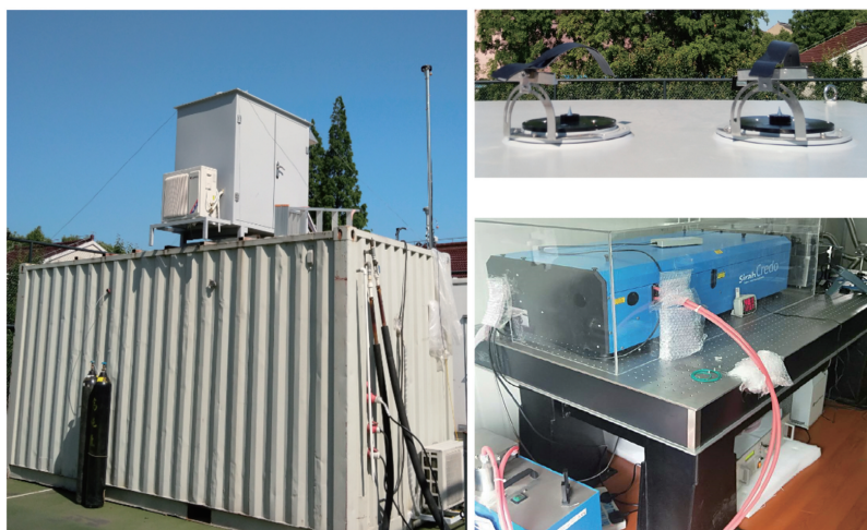
图 3 气体扩张激光诱导荧光技术系统(左上是整体,右上是采样口,右下是激光光源部分)
