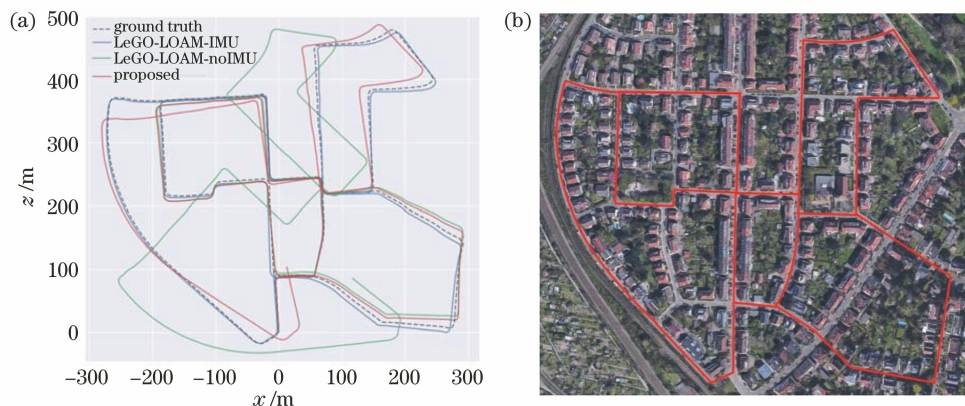
图 6 轨迹对比及真实场景图。(a)本文算法、LeGO-LOAM-IMU、LeGO-LOAM-noIMU 估计轨迹与真实轨迹对比; (b)轨迹所对应位置的卫星地图
