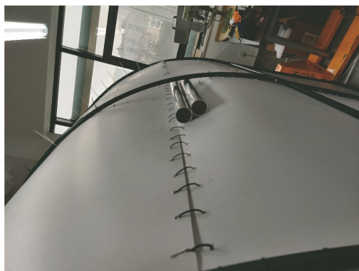
图 17 用物体压迫模拟隧道变形
