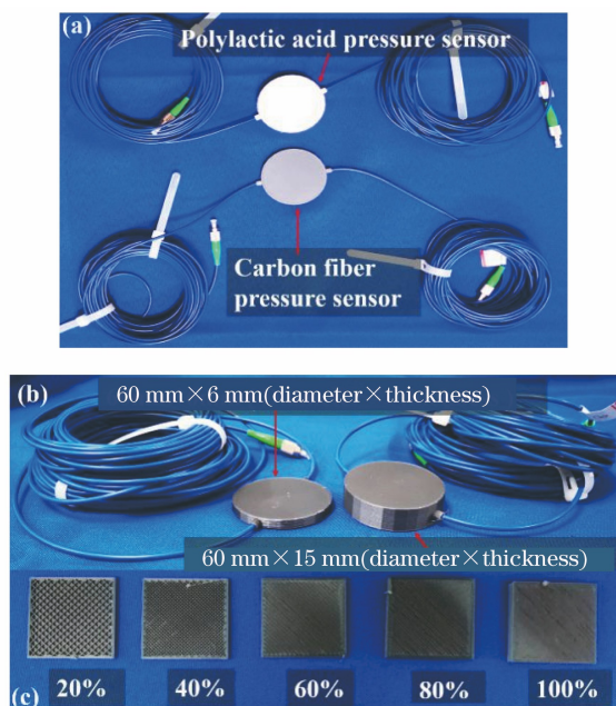
图 6 3D 打印的 FBG 土压力传感器。(a)不同封装材料；(b)不同填充模型尺寸；(c)不同封装密度
