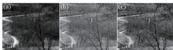
图 4 损失函数对结果的影响。(a)对抗损失+内容损失;(b)对抗损失+感知损失;(c)对抗损失+感知损失+内容损失
