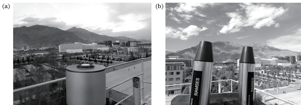
图 5 观测仪器。(a) NILU-UV 太阳紫外线探测仪; (b) RAMSES-ACC-UV 紫外光谱仪
