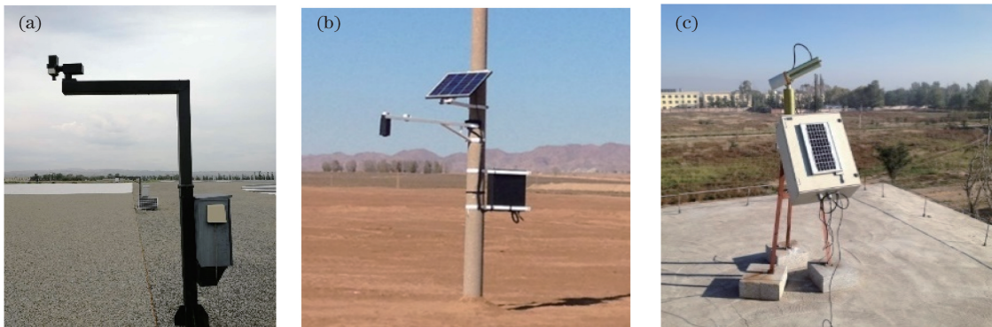
图 3 包头场自动观测系统。(a)固定靶标;(b)沙地目标;(c)CE318 太阳光度计
