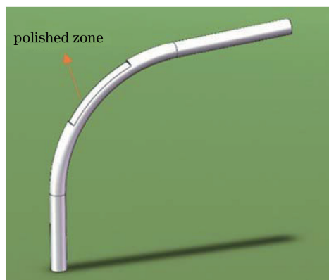
图1 强度增敏型光纤曲率传感器结构示意图
