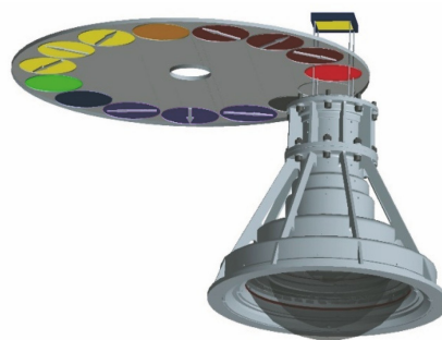
图 1 DPC 成像系统示意图
