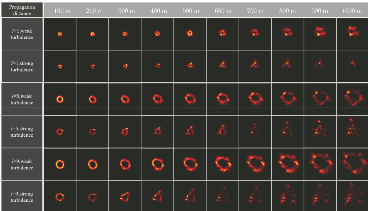
图 7 标量涡旋光束在大气湍流下的光强分布图像
