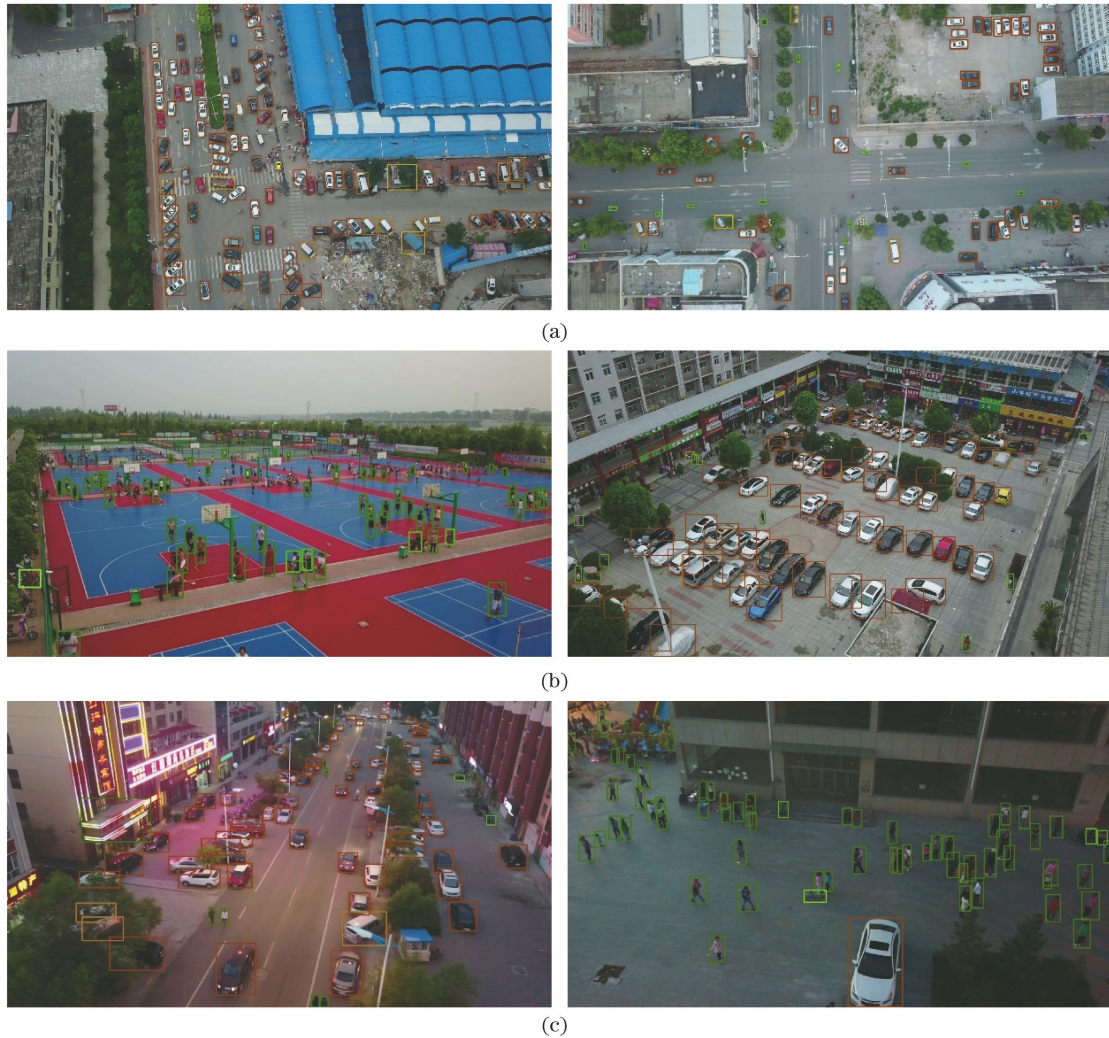
图 6 算法在不同情况下可视化检测结果展示。(a)小目标检测结果展示;(b)密集目标检测结果展示; (c)光照变化目标检测结果展示
