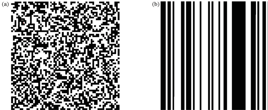
图3 二维随机编码与多狭缝组合编码对比。(a)二维随机编码;(b)多狭缝组合编码
