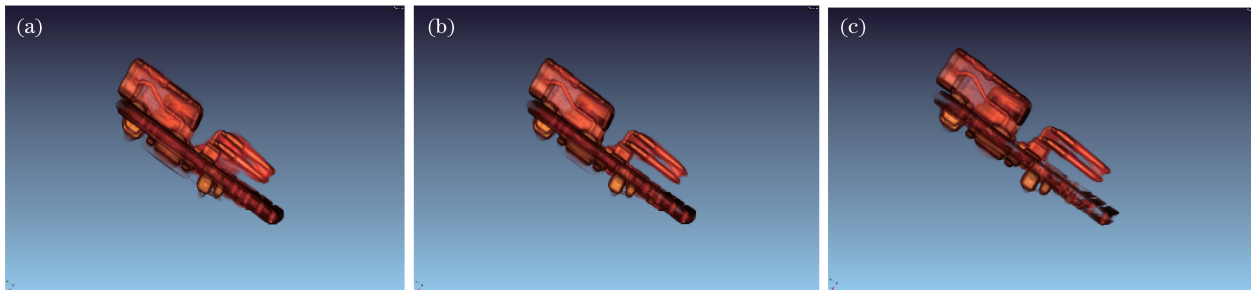
图 13 三维重建图对比。(a) 校正前的三维重建图;(b) BSA 散射校正后的三维重建图; (c) 硬化和 BSA 散射综合校正后的三维重建图
