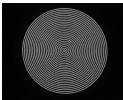
图 10 常亮投影方式下变形条纹图像
