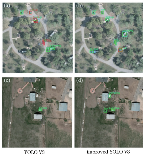
图 9 改进 YOLO V3 算法与原 YOLO V3 算法对小目标的检测结果对比
