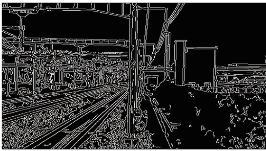
图 2 铁路场景边缘特征图 Fig. 2 Edge feature map of railway scene
