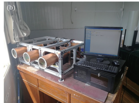
图 4 相关二维测风激光雷达系统。(a)结构图;(b)实物图
