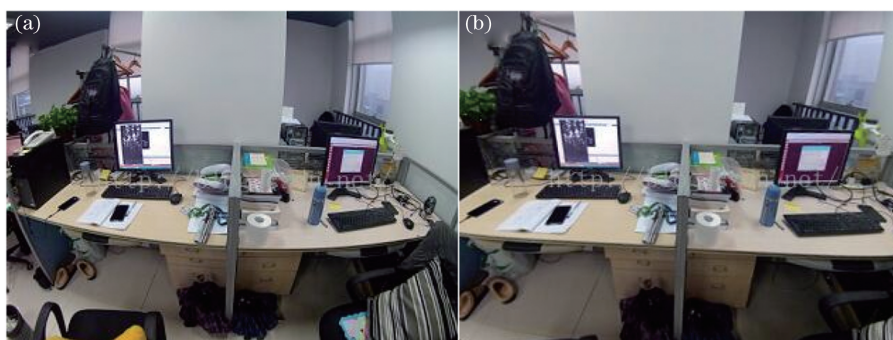
图 10 畸变校正效果示意图。(a)畸变校正前图像;(b)畸变校正后图像
