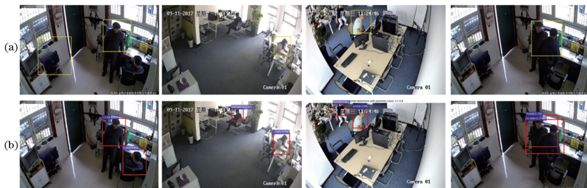
图 7 输入数据的区域建议结果比较。(a)HOG 特征结合 Adaboost 方法;(b)所提区域建议算法
