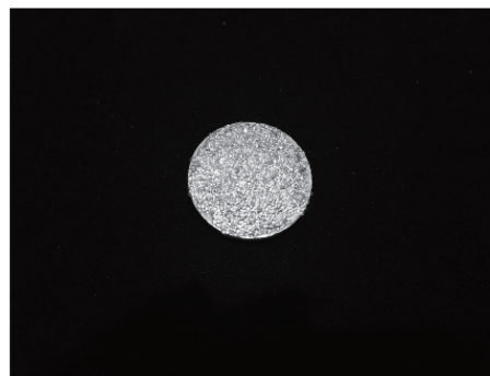
图 12 高反射基底样品在白炽灯下的反光情况
