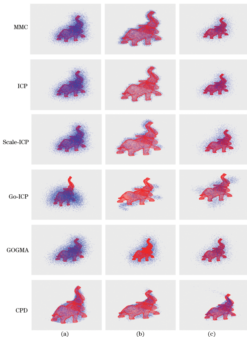
图 6 各算法配准后的 Elephant 点云对应关系。(a) 丢失 25% 数据的配准; (b) 丢失 50% 数据的配准; (c) 丢失 75% 数据的配准
