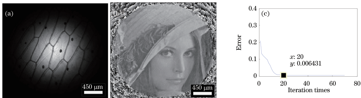
图 4 恢复待测物体出射光的(a)振幅和(b)相位;(c)迭代误差随迭代次数变化曲线
