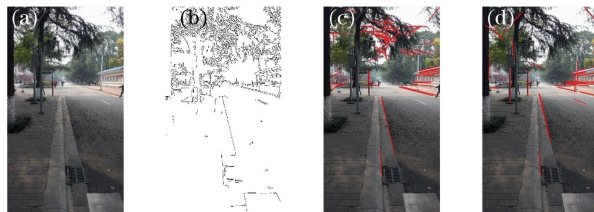
图 7 算法对边界聚合的抵抗效果。(a)原图像;(b) Canny 边界;(c) PPHT 结果;(d) 本文算法结果
