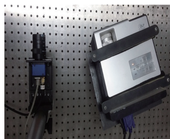
图 4 自适应条纹投影测量系统
