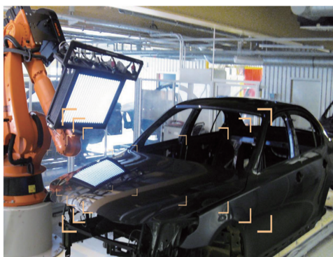
图4 油漆测试表面质量检测
