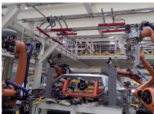
图 7 视觉引导机器人装配顶盖
