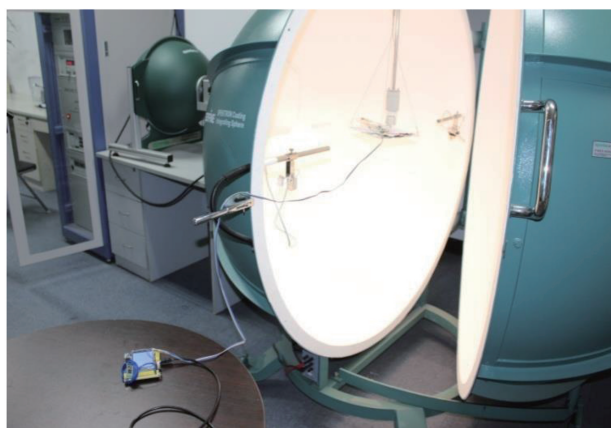
图 3 R/G/B/WW LED 光源模块测试系统
