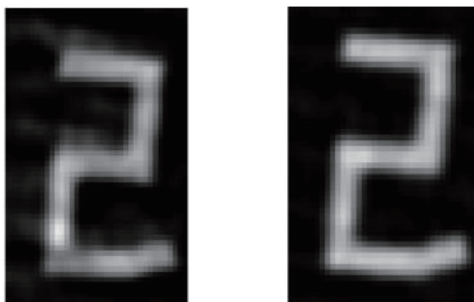
图 5 (a) 无像差校正时的复原图像; (b) 有像差校正时的复原图像 Fig. 5 Restored image (a) without and (b) with aberration correction
