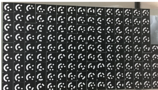
图 7 摄像机标定靶标实物图
