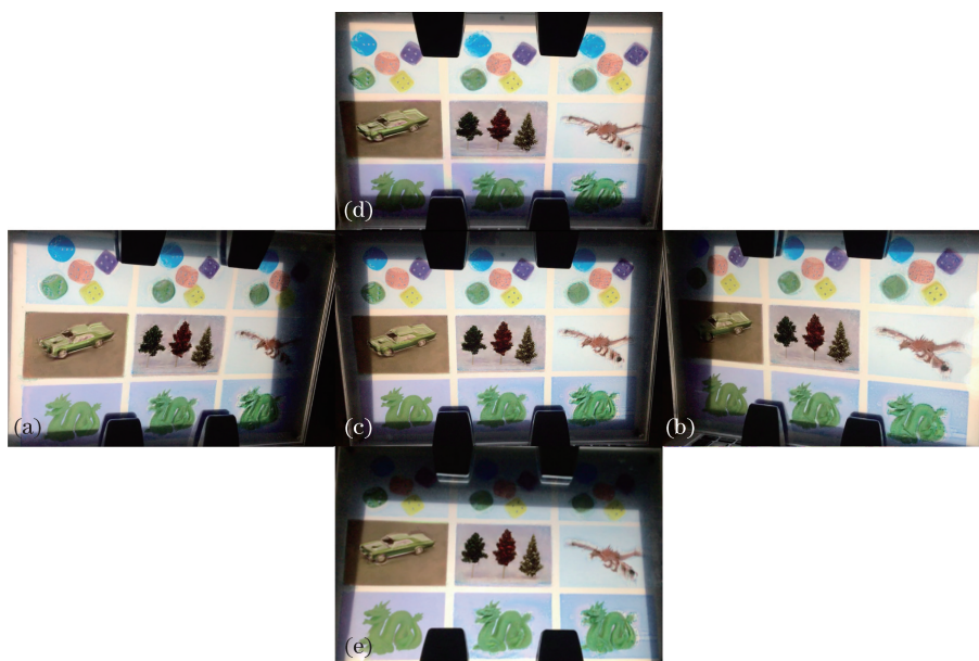
图 9 多层平面三维显示系统各个视角图。(a)左方视角；(b)右方视角；(c)中央视角；(d)上方视角；(e)下方视角
