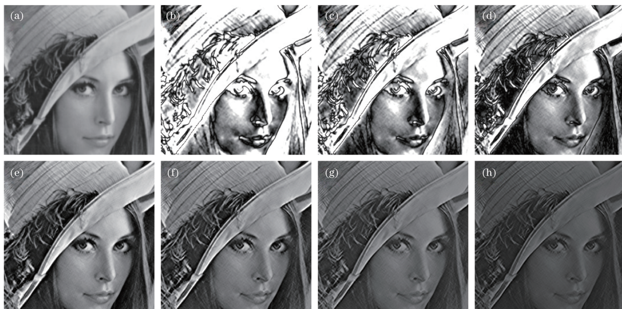
图 3 Lena 模糊图像及其复原结果(局部放大)。(a)经 (\alpha=0.1, \beta=5/6) 模糊的 Lena 图像; (b) A=0 ; (c) A=-0.5 ; (d) A=-1 ; (e) A=-1.5 ; (f) A=-2 ; (g) A=-2.5 ; (h) A=-3
