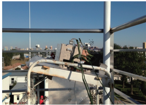
图 7 前向临边成像光谱仪外场实验装置图
