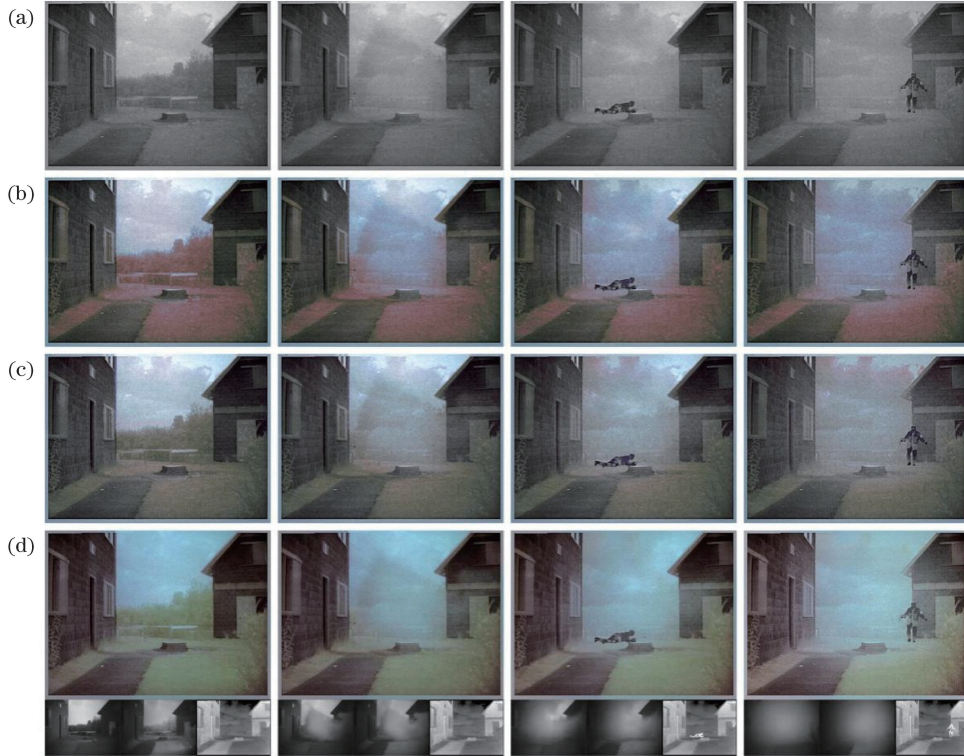
图 9 灰度校正及彩色融合对比。(a)拉普拉斯金字塔融合图像;(b)本文算法灰度校正前;(c)本文算法灰度校正后;(d) Toet 算法
