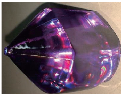
图 1 生长出的 In:Nd:LiTaO_3 晶体
