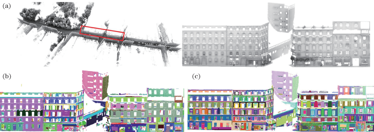
图 8 数据 Data1 平面分割结果(不同颜色区分不同平面)。(a)数据 Data1 及其局部; (b) OB 算法分割结果;(c)本算法分割结果
