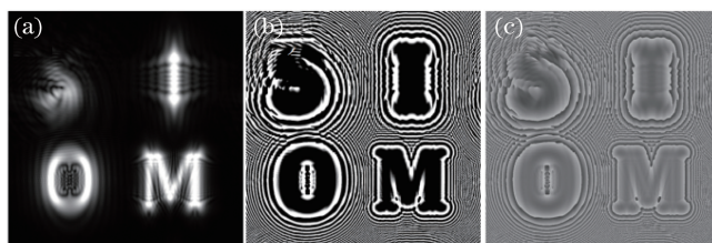
图 4 三维物体的全息图及相位编码图。(a)振幅图;(b)相位图;(c)相位编码图
