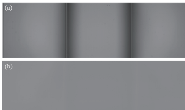
图 9 辐射校正前后的定标图像。(a)相对辐射校正前的渐晕图像;(b)相对辐射校正后的图像
