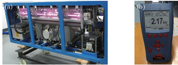
图 6 (a)轴快流 CO 2 激光器实验平台外观图和(b)功率检测结果
