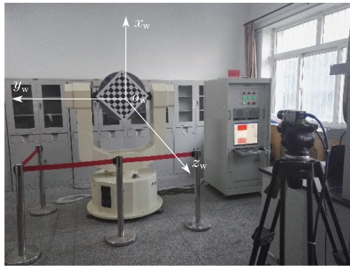
图 5 单目视觉姿态测量实验系统
