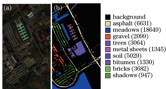
图1 PaviaU 高光谱图像。(a)假彩色图;(b)真实地物图
