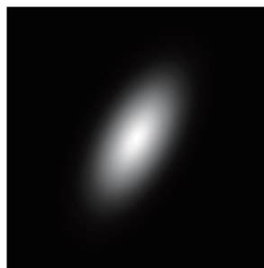
图 3 60°散光的 PSF 仿真图像 Fig. 3 Simulation image of 60° astigmatism
