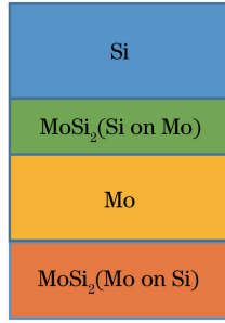
图 1 一个周期内的 Mo/Si 多层膜的四层模型结构示意图
