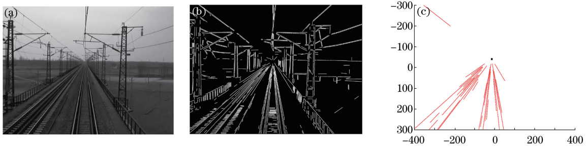
图 6 基于直线检测确定场景消失点。(a) 视频中随机选取的一帧; (b) 直线检测结果; (c) 消失点检测结果
