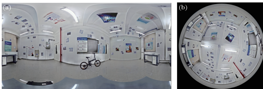
图 4 (a) 柱面投影图转换为 (b) 球面投影图
