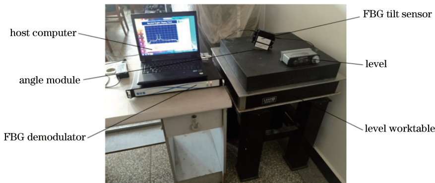
图 4 倾角传感器测试实物图
