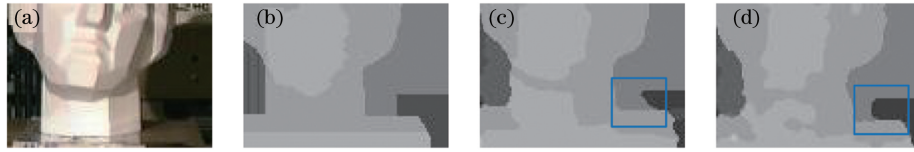
图 1 AD-Census 和本算法得到的视差图。(a)参考图像;(b)真实视差图;(c) AD-Census;(d)本文算法
