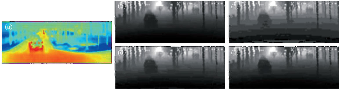
图 3 将红外视频真实深度分割成不同深度层数的效果。(a)红外视频;(b)真实图像;(c) 10 层;(d) 20 层;(e) 30 层
