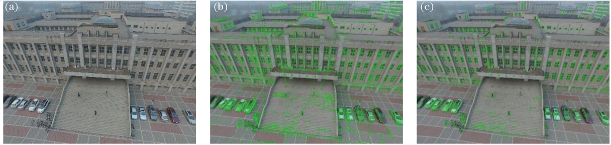
图 3 航拍图像 MSER 特征提取。(a) 原图；(b) MSER 特征；(c) 改进后的 MSER 特征
