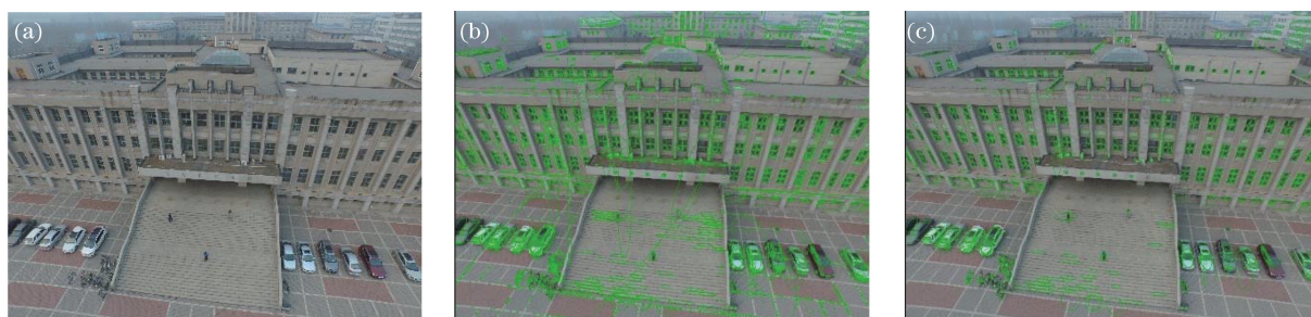
图 5 航拍图像筛选前后极值区域对比。(a) 原图；(b) MSER 特征；(c) 改进的 MSER 特征
