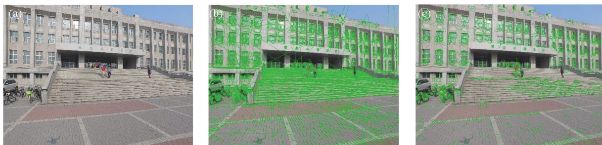
图 4 模拟街景图像筛选前后极值区域对比。(a) 原图；(b) MSER 特征；(c) 改进的 MSER 特征
