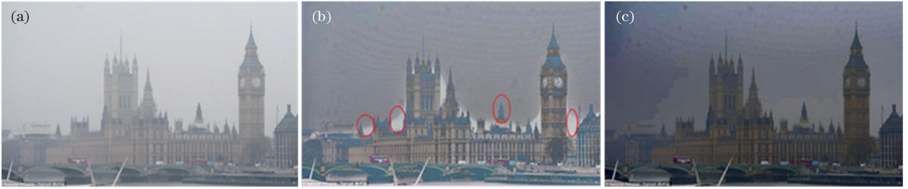
图4 现有算法的去雾结果。(a)原始有雾图像；(b)文献[11]算法的去雾图像；(c)文献[13]算法的去雾图像
