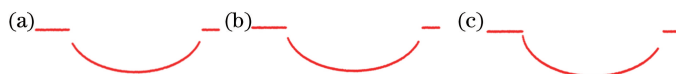
图 10 旋转 \beta 角时滑块的轮廓图像。(a) \beta=0^\circ ;(b) \beta=2^\circ ;(c) \beta=5^\circ
